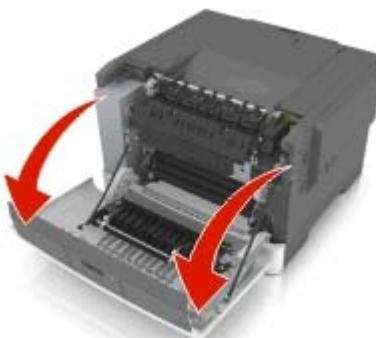
**2** 滑动打印机右边的释放插销，然后打开顶部盖门。
