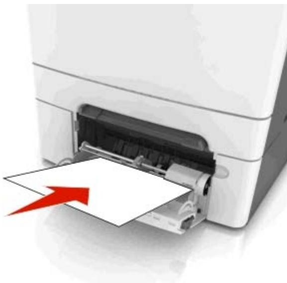
4 滑动纸张导片，直到它轻轻地靠着纸堆的边缘。
