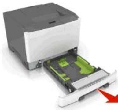
**2** 压住宽度导片凸柱，然后将它滑动到与您加载的纸张相符的正确位置上。
