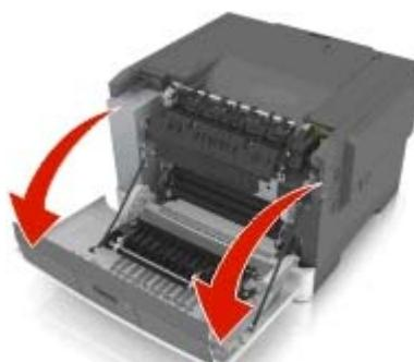
3 滑动打印机右边的释放插销，然后打开顶部盖门。
